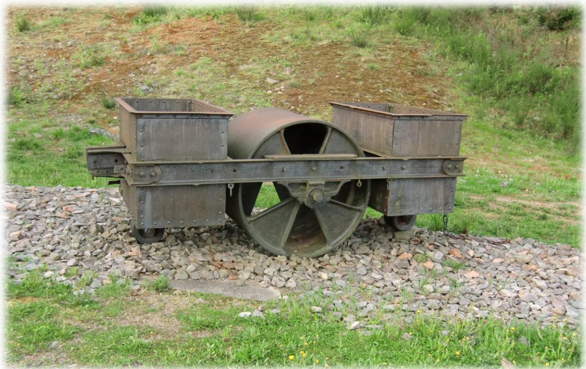
Eén van de eerste pletwalsen die werden voortgetrokken door paarden. Deze pletwals werd gebruikt om aardewegen te verharderen om modderwegen te vermijden.
