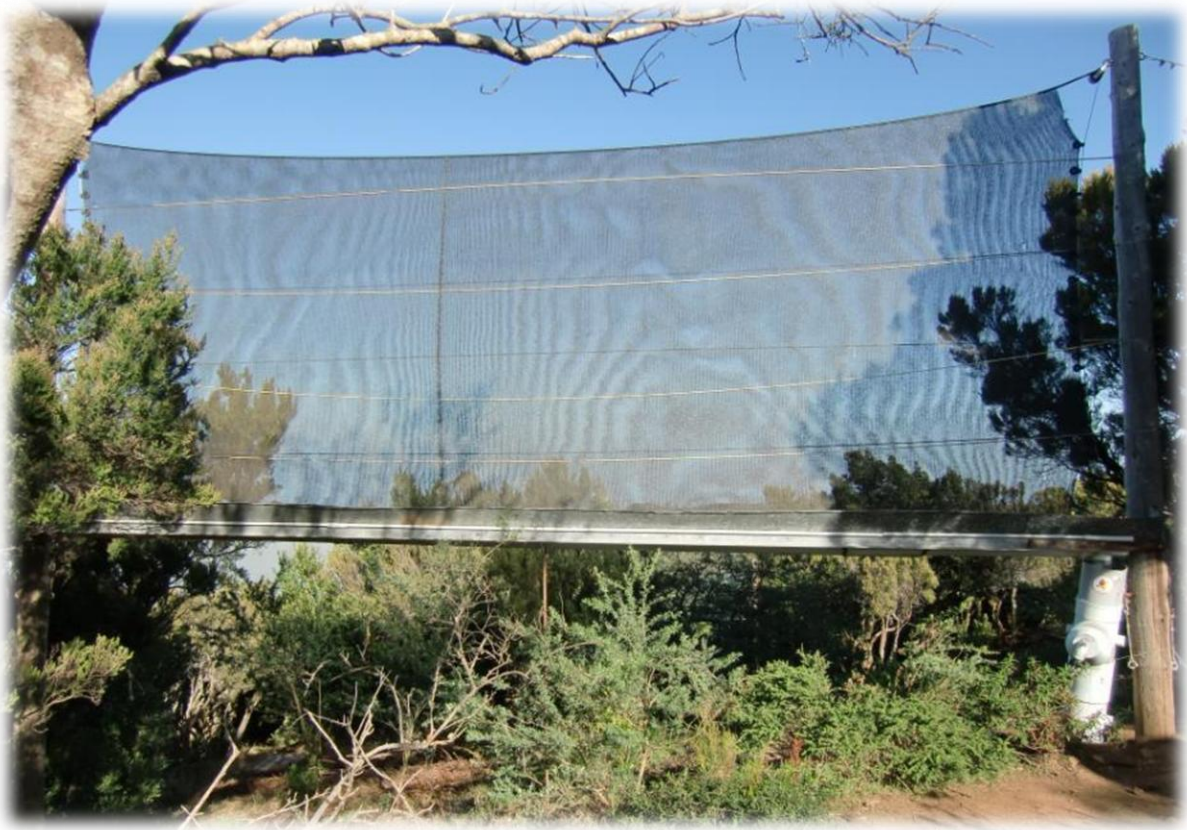
Hier en daar zien we netten hangen waarmee regen- en condenswater wordt opgevangen.
