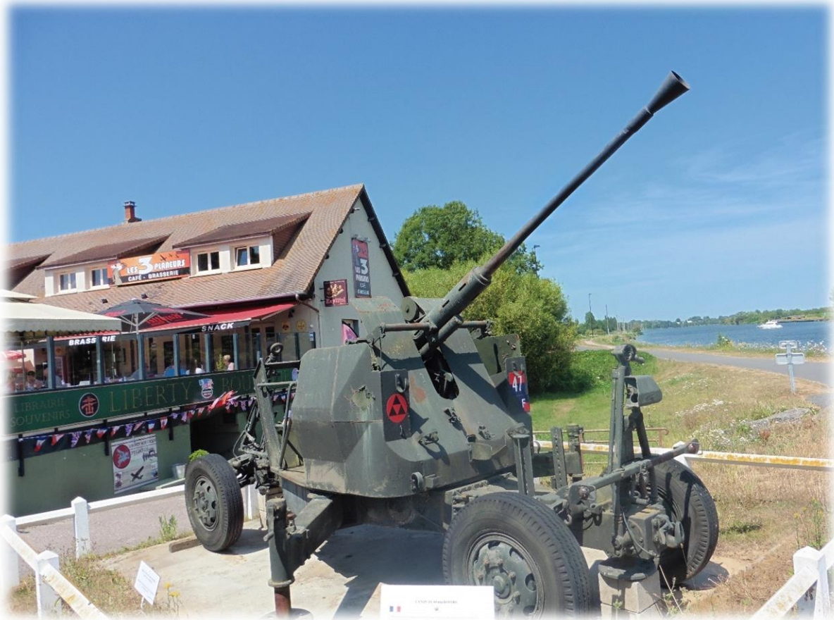
Dit 40 mm kanon Bofors weegt 2 ton en werd door 8 mensen bediend. Ze konden doelen raken tot op 1500 meter.
